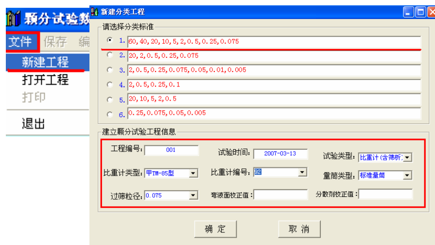
图 3-28 建立筛分试验工程
